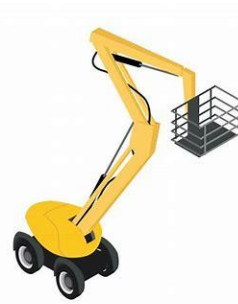
Nacelle élévatrice Source : Prévention BTP
